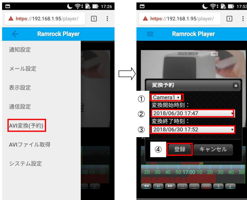
① AVI 変換したいカメラを選択し、②変換開始時刻と③変換終了時刻を指定し、④登録します。
