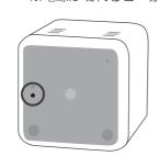
注意) 点滅中はシャットダウン処理中のため、 AC アダプタを挿さないでください。
